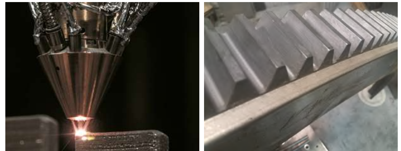
Образец. Наплавка направляющей поверхности. Восстановлено 0.9 мм
